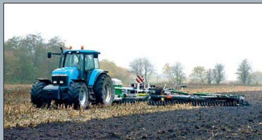
Výkonnosť 12 m verzie pri pracovnej rýchlosti 15 km za hodinu sa pohybuje do 15 ha. Výrobca pritom udáva spotrebu 2,5 až 4 l na hektár traktorov s výkonom od minimálnych 250 koní.
