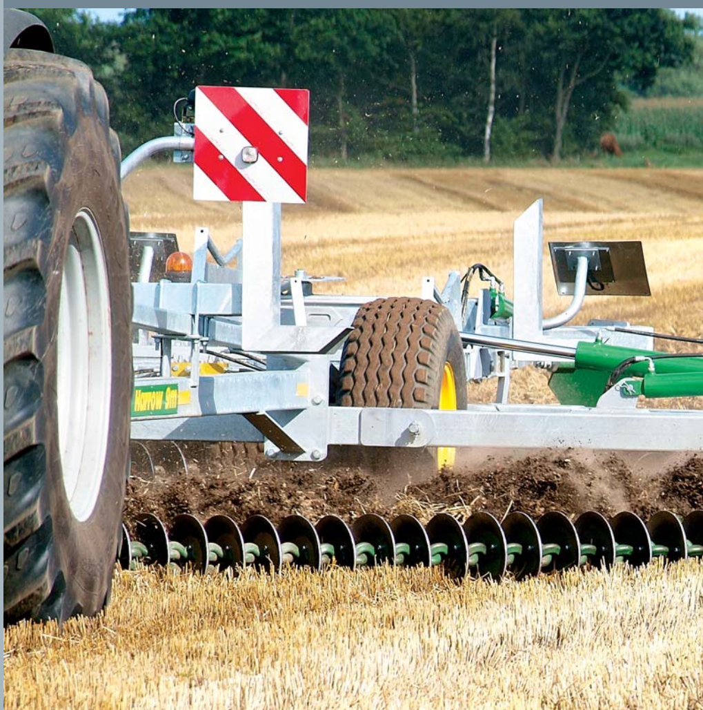
Výkonnosť 12 m verzie pri pracovnej rýchlosti 15 km za hodinu sa pohybuje do 15 ha. Výrobca pritom udáva spotrebu 2,5 až 4 l na hektár traktorov s výkonom od minimálnych 250 koní.
