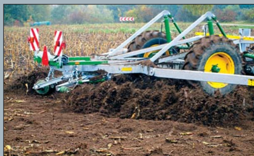
Pracovná hĺbka sa nastavuje v rozmedzí od 2 do 7 cm.
