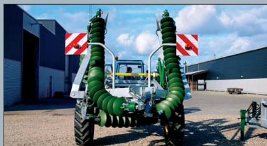
Reťaz z diskov sa vďaka svojej ohybnosti dostáva do prepravnej polohy veľmi jednoducho. Prepravná šírka je pri všetkých modeloch menej ako 3 m a prepravná výška maximálne 3,7 m pri 6 m verzii.
