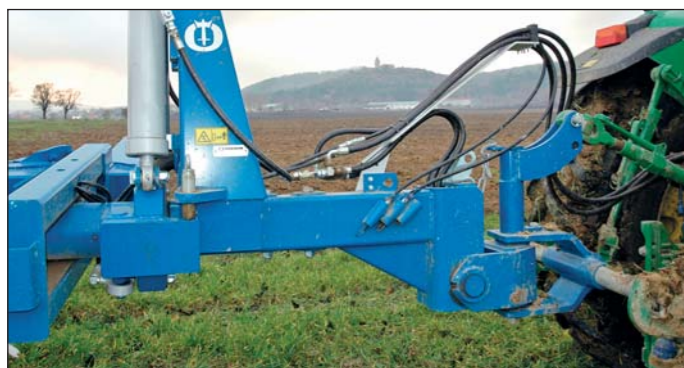
Otočný mechanizmus pozostáva z dvoch hydraulických piestov. Pluh dopadá na vymedzovacie skrutky, ktorými sa zároveň nastavuje vodorovná poloha pluhu. Pochválit treba aj priestor na odkladanie hadíc v odstavnej polohe.
