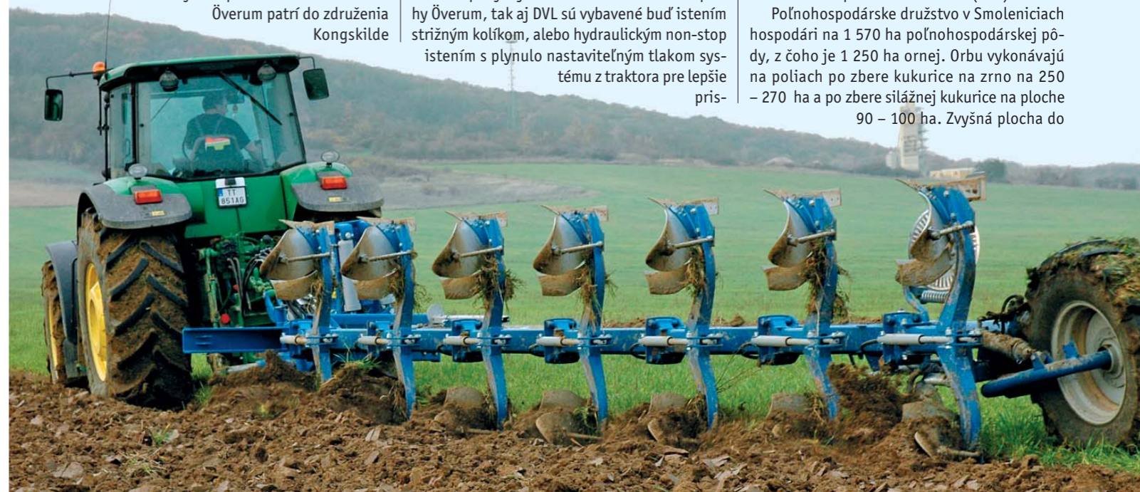
Pluh Överum DVL švédskej výroby v Smoleniciach agregovaný traktorom John Deere 8230. Podobný, ale šesťradličný pluh kúpili ako ojazdený v roku 2002.
