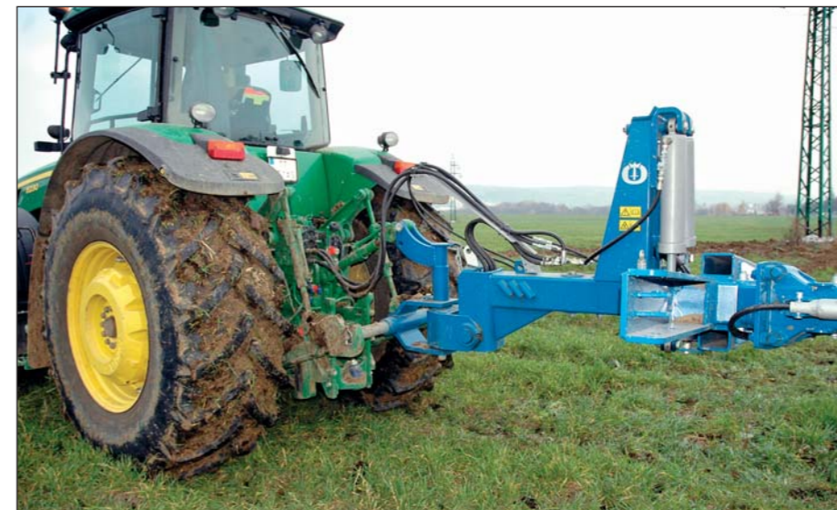
Na správnu funkciu pluhu stačí zapojiť jeden jednočinný a jeden dvojčinný okruh.
