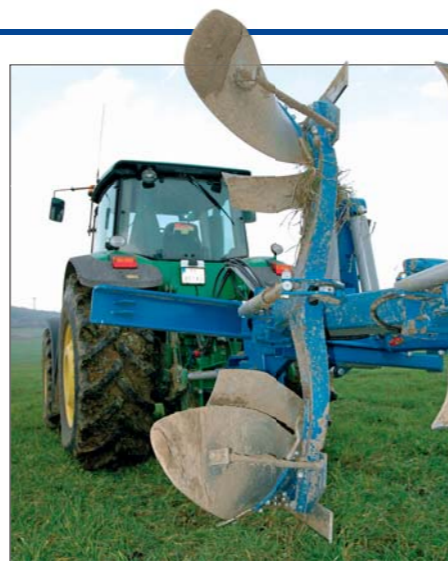
Nastavenie záberu prvého orbového telesa sa uskutočňuje pomocou hydrauliky z kabíny traktora.
