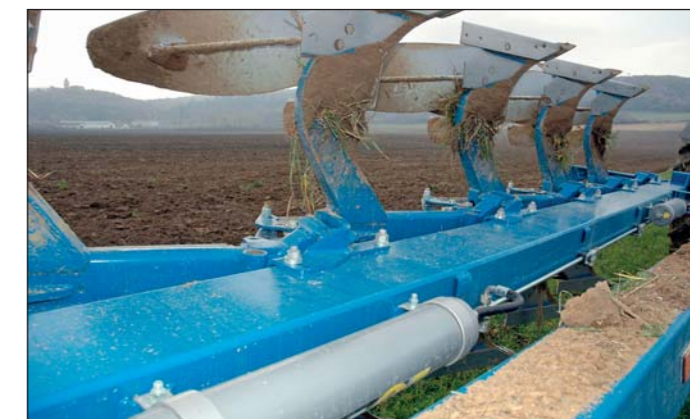
Záber jednotlivých orbových telies sa mení mechanicky pomocou skrutky v troch stupňoch.
