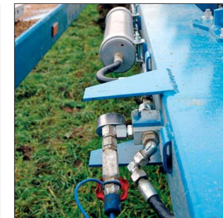
Non-stop istenie proti kameňom v pôde funguje veľmi dobre. Špičku pluhu dovoľuje nadvihnúť 50 cm nad úroveň v pracovnej polohe a 10° do boku. Vylepšit by výrobca mohol ukazovateľ tlaku z kabíny takmer nečitateľný.
