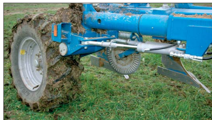
Záhonové koleso má dostatočný priemer a šírku, aby pluh držalo stabilne i pri preprave po ceste. Jeho správne nastavenie je dôležité pre dobrú orbu.
